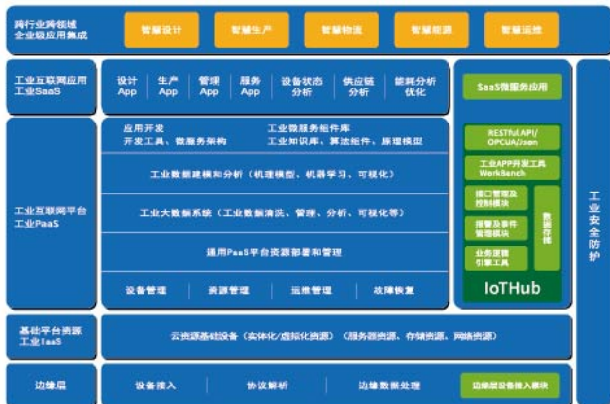
宜科 IoT Hub™ 对其他工业互联网平台的赋能框架
