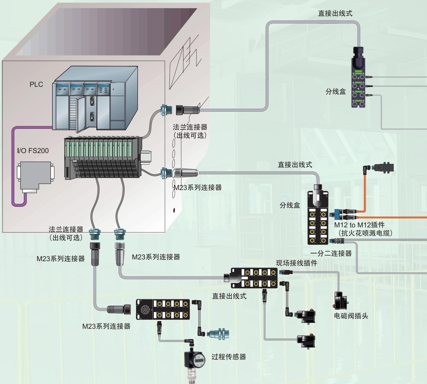
ELCO连接系统标准连接器已经覆盖了2、3、4、5、8芯的产品，可与多种传感器包括接近、光电、超声波、过程（压力、流量）、机械限位等多种传感器，以及安全光幕、编码器等产品配套使用。电缆连接器产品除了标准产品外，也可以通过客户化定制电缆的护套材质、长度及插头功能，可以满足不同工况现场快速连接的需求。
