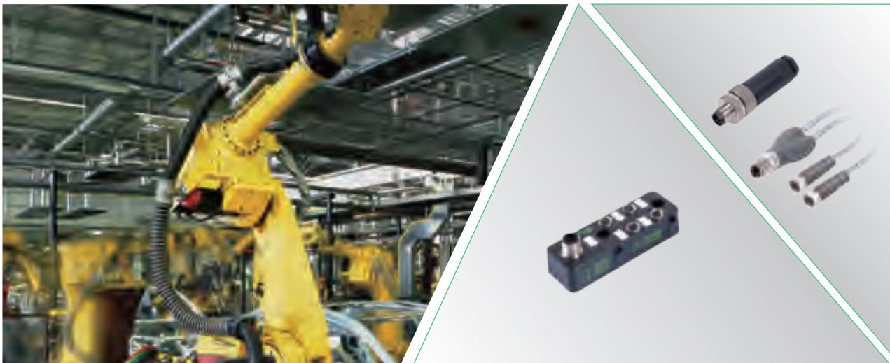
工业机器人已经广泛应用于各行各业，包括焊接、搬运、切割、喷涂等多种应用类型。结合工业机器人设备运行过程中的一些特殊情况要求，主动、被动连接解决方案都有应用，其中现场的预注连接器均采用柔性或防火花喷溅的电缆，以便满足设备运行机构及环境要求。
