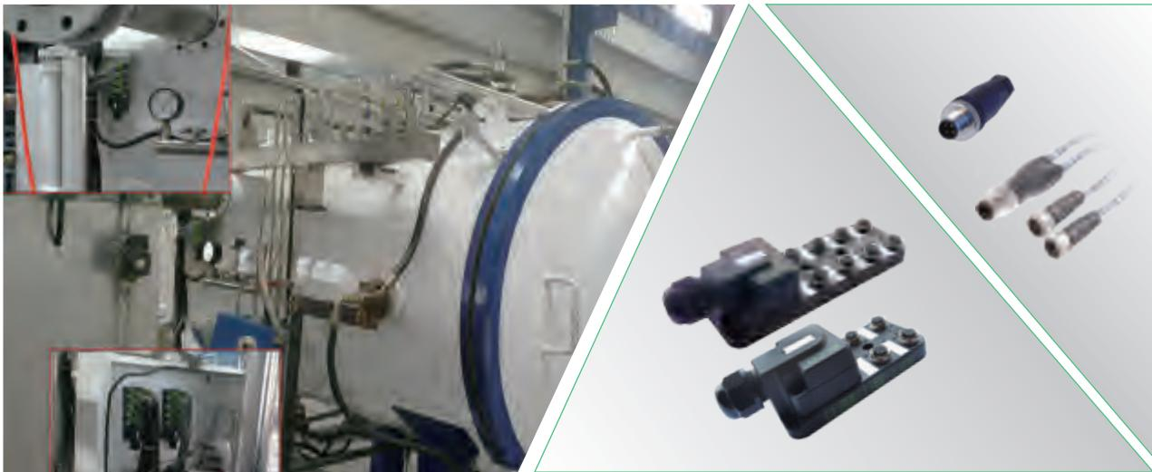
粉末冶金工业炉是材料处理的主要设备，其设备主体有烧结、脱蜡等多个组件构成，包括接近开关、压力开关、流量开关、执行器等组件需要连接。
