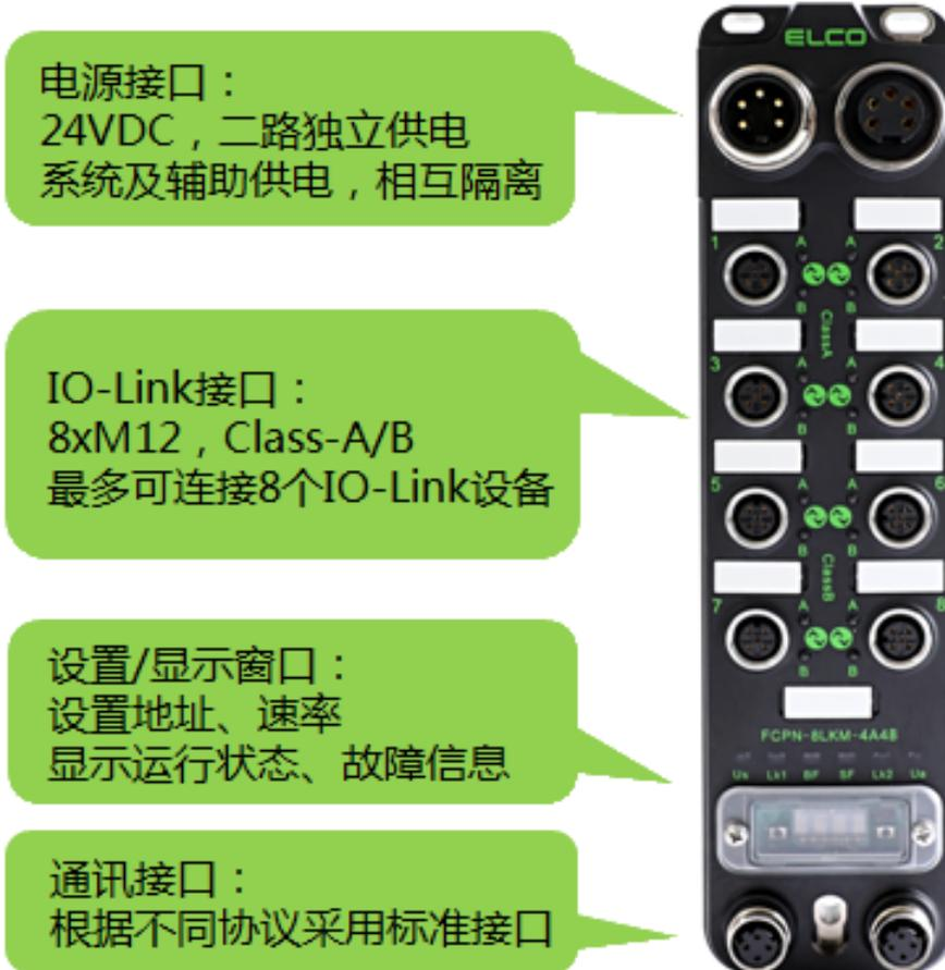
每个 Compact67 系列 IO-Link 主站模块占用一个 EtherNet/IP 从站地址，根据型号不同，最多的可以连接 8 路 IO-Link 设备，根据具体需求选择 Class-A 或 Class-B 接口类型的模块。
