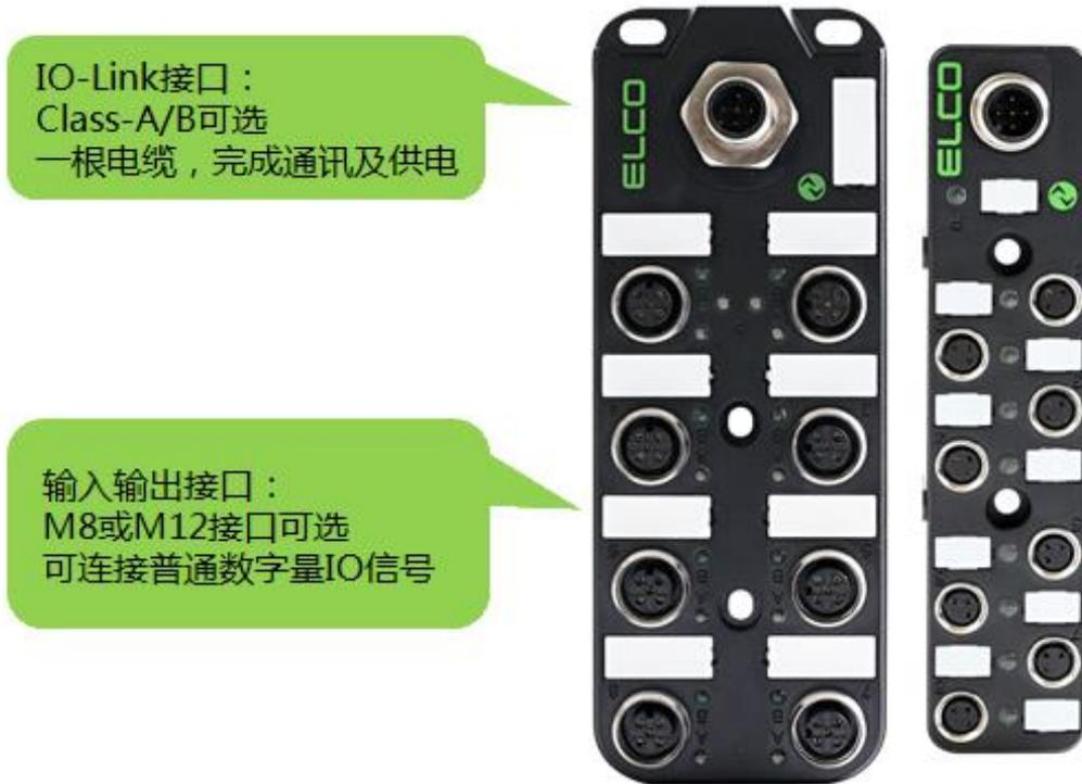
Compact67 系列 IO-Link 信号集线器，可作为 IO-Link 子站与宜科或其他品牌的 IO-Link 主站相连接，符合 IO-Link v1.1 标准，支持 COM2 (38.4kbps) 通讯速率。IO-Link 主站模块的每个 IO-Link 接口均可扩展一个 IO-Link 集线器用来采集输入输出信号，即 8 端口的 IO-Link 主站模块加 8 块 IO-Link 集线器，最多可以连接 128 个开关量信号。
