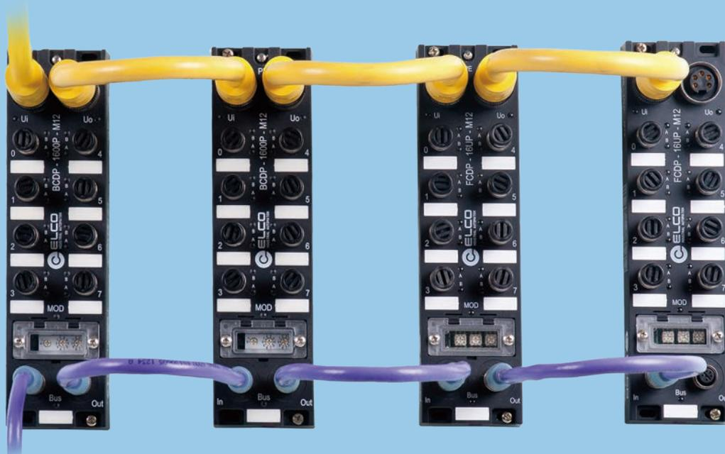
Compact67系列产品为连接控制器并应用在恶劣现场环境下的现场总线I/O系统提供可靠，值得信赖的解决方案。
